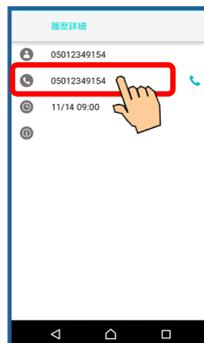
ダイヤル画面が表示されるので、プリセットされた電話番号を確認して「発話ボタン」をタップまたは、タブバーの「回線」をタップして空いている外線ボタンをタップします。その後、選択した履歴の電話番号へ外線発信をします。
