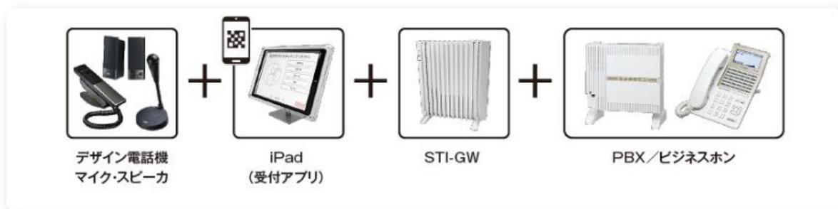
「受付アプリケーションをインストールしたNYC-MICROSV2-LANとUSB接続したNYC-STI-GW」を電話機システムに接続し、NYC-STI-GWに接続のアナログ電話機などから、電話機システムの内線電話機を呼び出すことができます。
