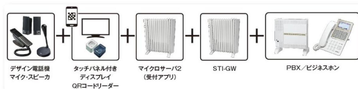
「受付アプリケーションをインストールしたNYC-MICROSV2-LANとシリアルケーブルで接続したIPカメラドアホン」から、電話機システムの内線電話機を呼び出すことができます。
